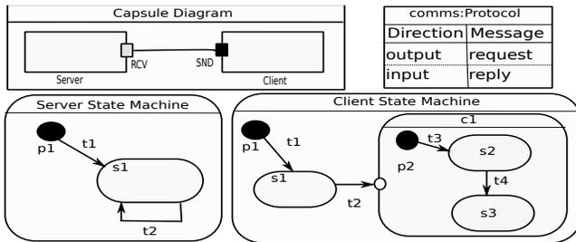
Figure 2: Client-Server UML-RT Model
